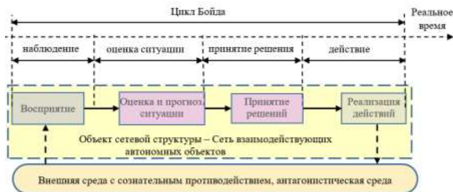
Рис. 1. Цикл Бойда в системе управления реального времени
