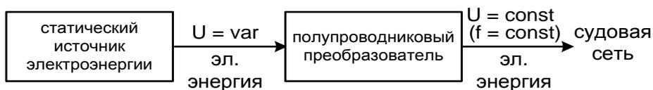
Рис. 6. Функциональная схема вентильного статического источника электроэнергии
