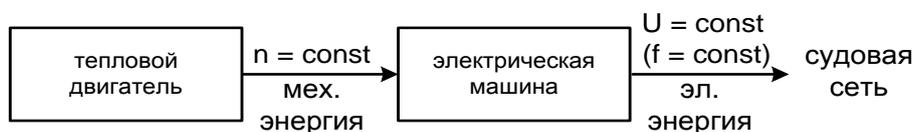
Рис. 2. Функциональная схема традиционного генераторного агрегата
