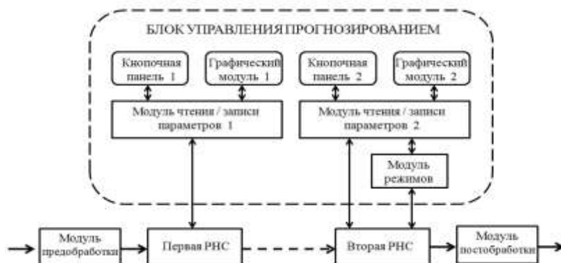
Рис. 1. Архитектура программной системы нейросетевого прогнозирования
