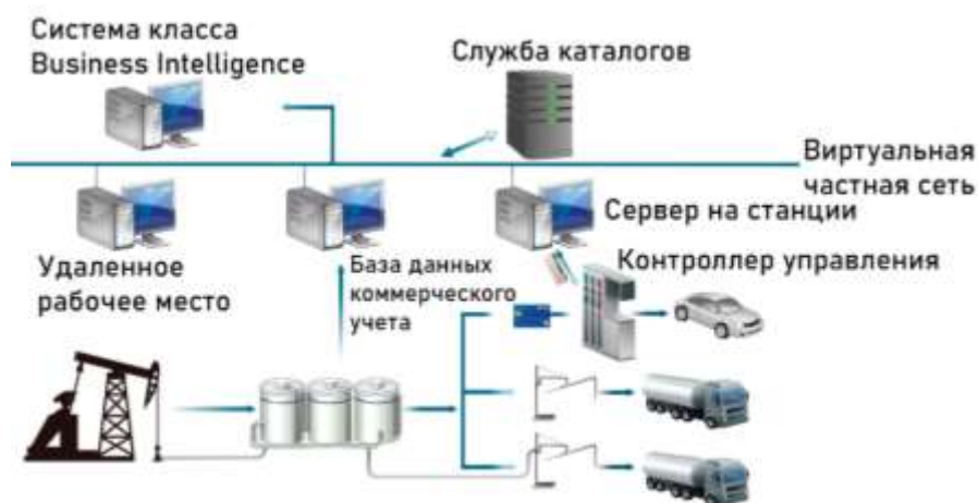
Рис. 3. Схема серверов для обработки данных
