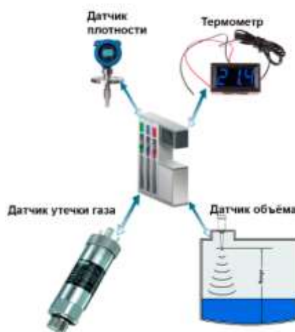
Рис. 1. Датчики контроллера управления
